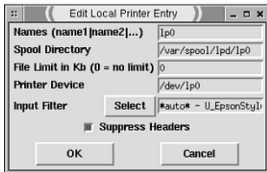
Figura 20.2.: Configurazione di una stampante locale.
